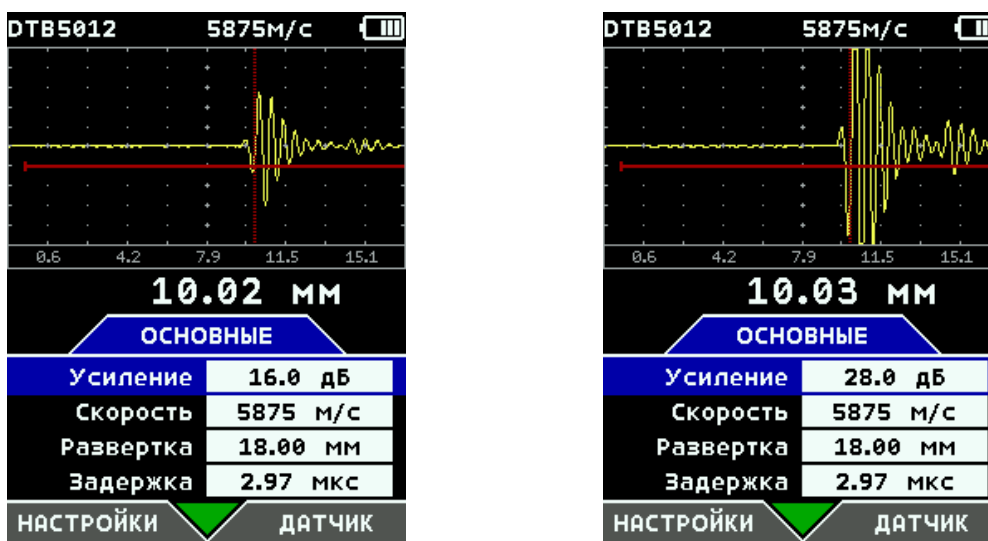
Рис.6-6. Иллюстрация эффекта от изменения коэффициента усиления а) усиление 16дБ, б) усиление 28 дБ.
