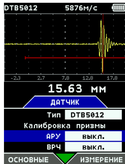
Рис. 6.-18 Измерение разных толщин без использования АРУ.
