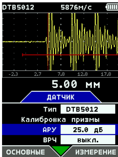
рис. 6-17 Измерение разных толщин с использованием АРУ
