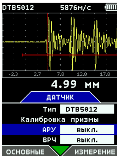
Рис. 6.-18 Измерение разных толщин без использования АРУ.
