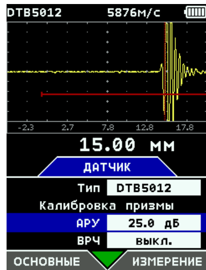
рис. 6-17 Измерение разных толщин с использованием АРУ
