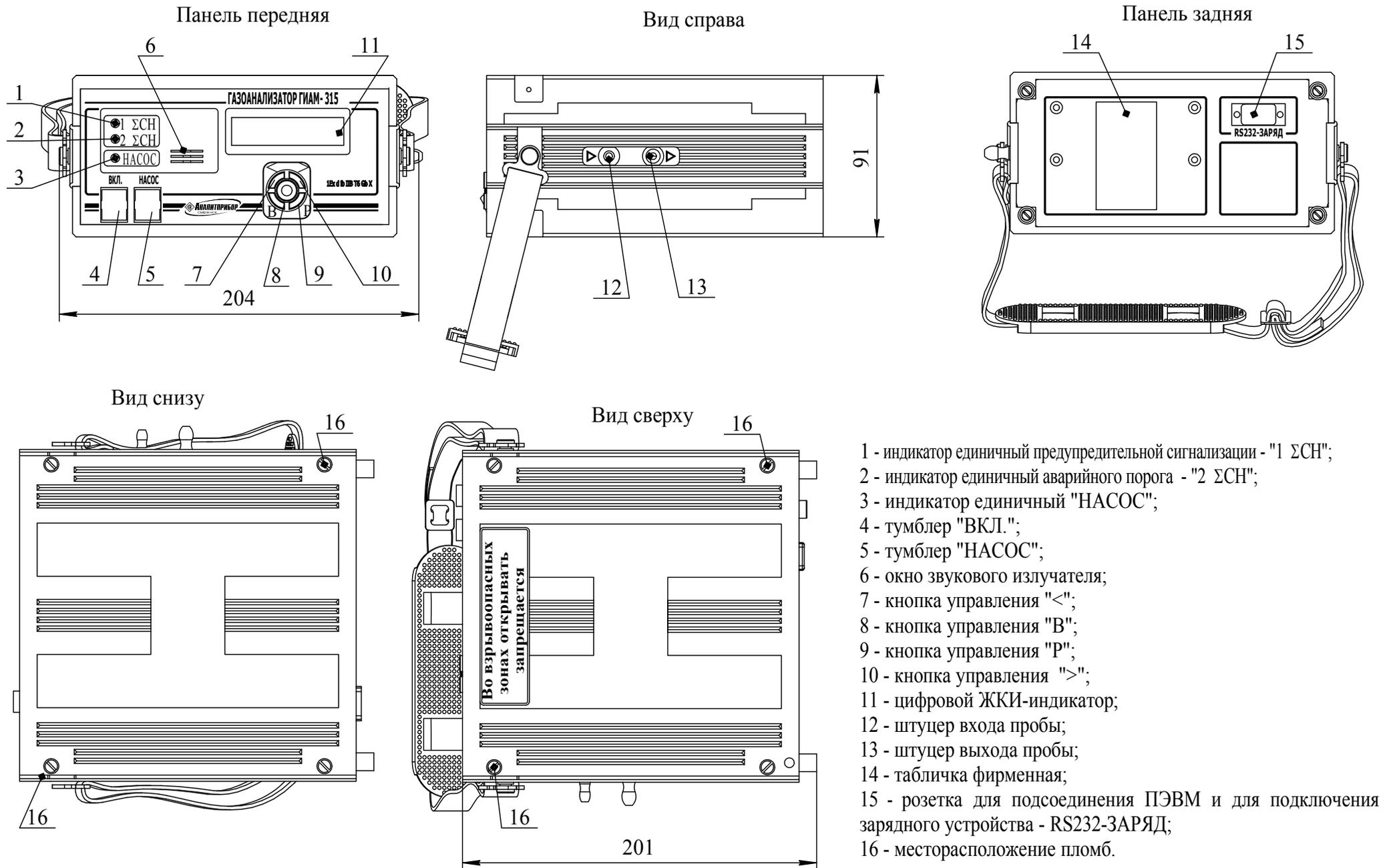
Рисунок 1.1 - Газоанализатор ГИАМ- 315. Внешний вид
