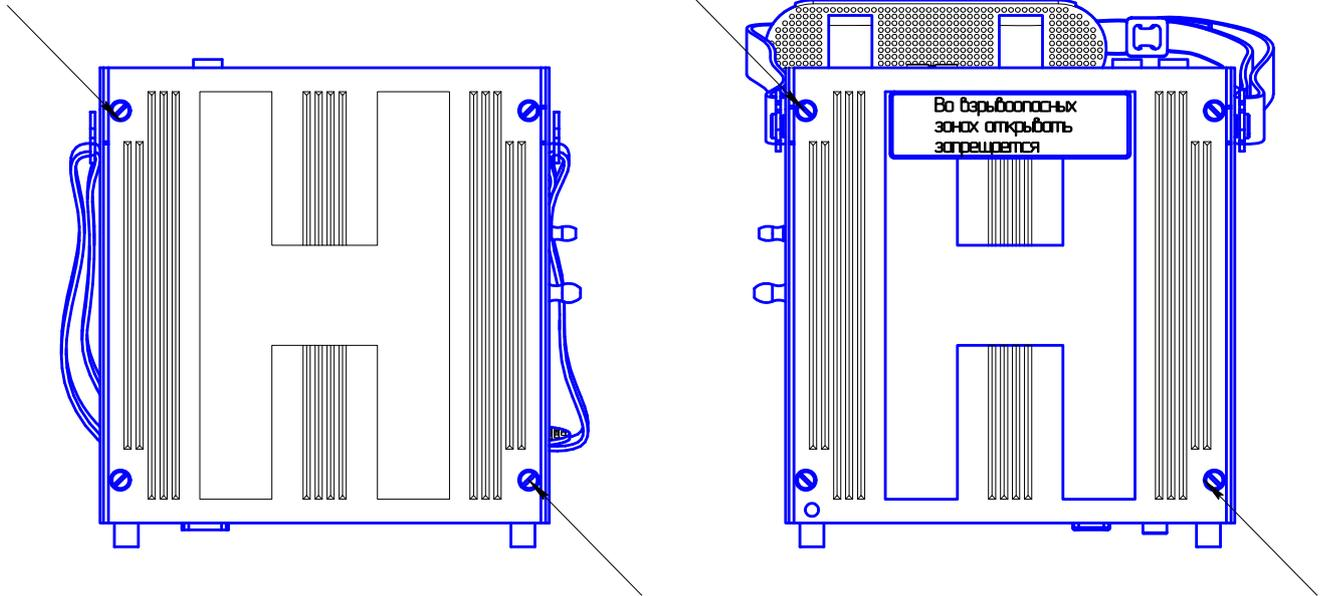
Стрелками указаны места пломбировки газоанализатора от несанкционированного доступа и обозначение места для нанесения оттисков клеем.
