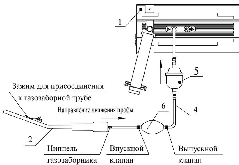
г) принудительный забор пробы с помощью газозаборника ИБЯЛ.418311.014 (температура окружающего воздуха от минус 30 до минус 10 °С)
