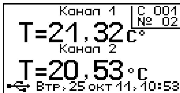
При выборе режима измерения **«По сериям»** в правом верхнем углу отображаются номер серии и номер измерения. Одна серия соответствует одному циклу регистрации.
