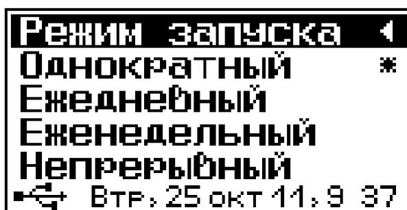
**Однократный режим** – прибор проведет цикл измерений однократно после чего, будет ждать следующего запуска регистрации пользователем.
