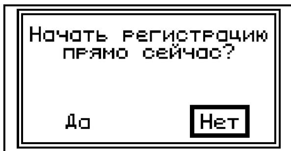
Если выбрать «да», то цикл регистрации начнется с немедленного измерения, прибор проведет измерение и выключится, ожидая следующего измерения в соответствии с настройками режима запуска.
