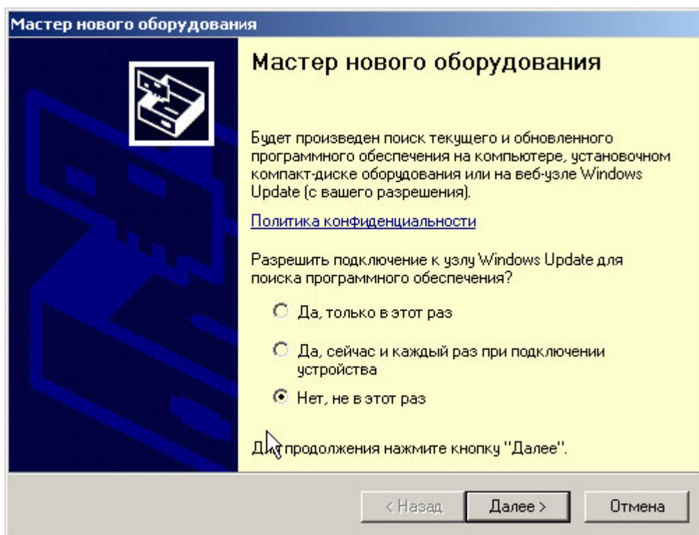
На предложение поиска программного обеспечения на узле Windows Update следует ответить «Нет, не в этот раз» и нажать кнопку «Далее». В следующем окне нужно выбрать «Установку из указанного места»:
