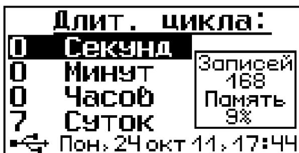
позволяет устанавливать интервал времени всей регистрации с помощью клавиш «↑», «↓», «▼», «▲». Длительность цикла не может быть меньше периода отсчетов, так как в одном цикле должен быть как минимум один замер. Во вспомогательном окошке справа отображается:
