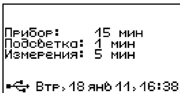
Если прибор подключен к внешнему питанию через USB, то автоотключение режима измерения неактивно.
