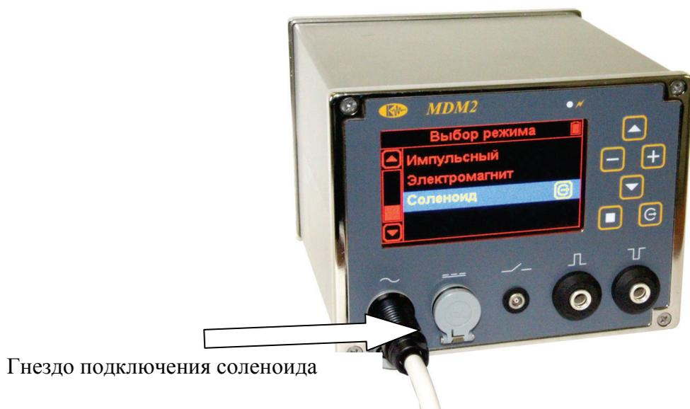
Рис 4.8 Подключение соленоида к дефектоскопу
