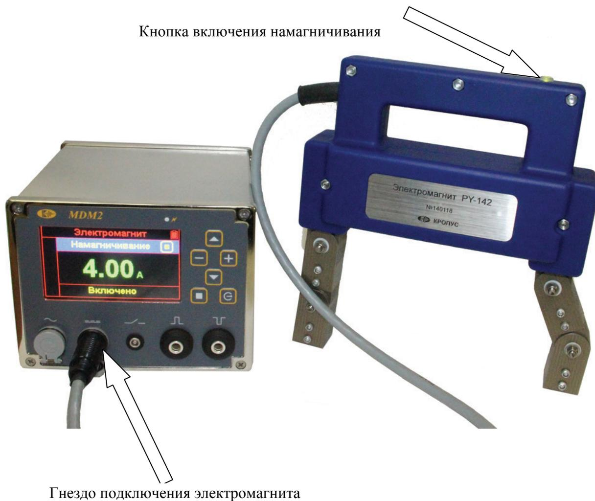
**Рис 4.7** Подключение электромагнита к дефектоскопу
