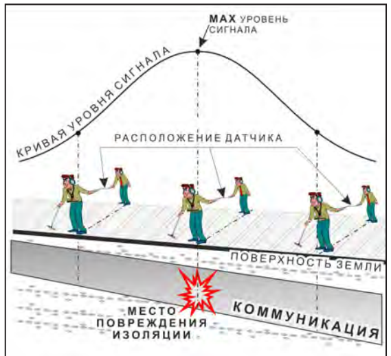
применение датчика-определителя дефектов коммуникации (ДОДК) методом max
